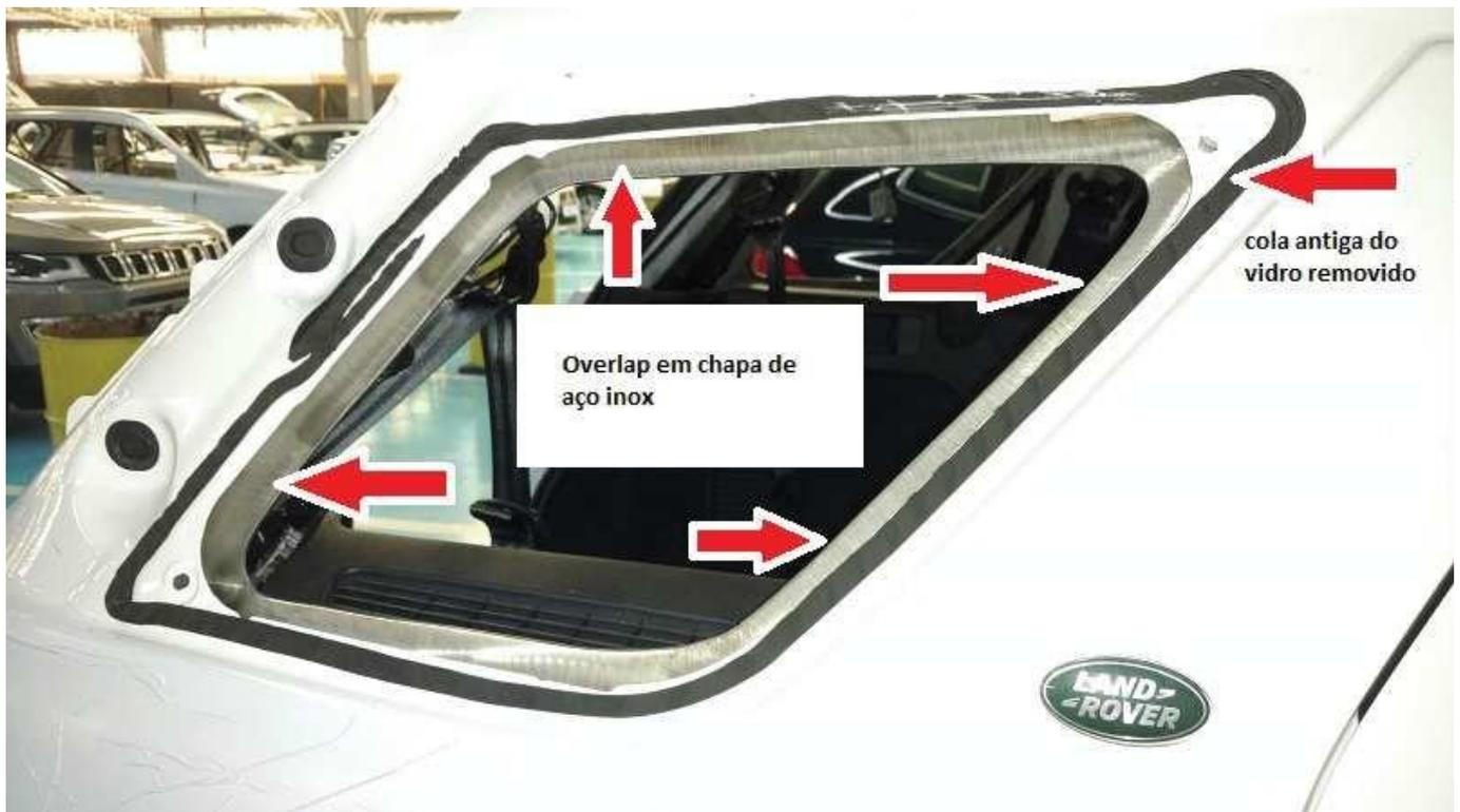
Figura 3 – Exemplo de *overlap* nos quadros dos vidros fixos
