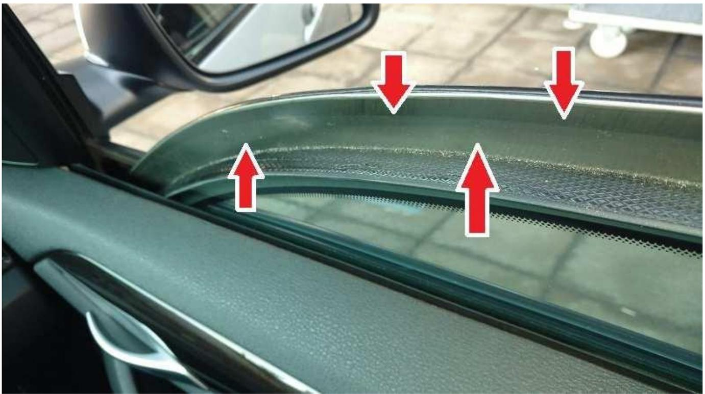
Figura 7 – Detalhe do reforço em aço na região do *offset* do vidro da porta dianteira
