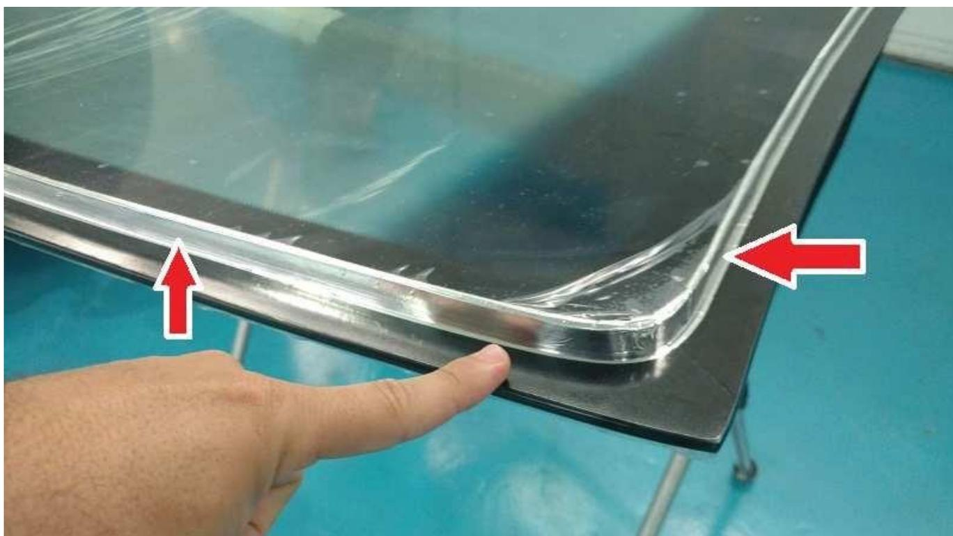
Figura 9 – Fita de alumínio aplicada à lateral do pacote de forma a evitar a contaminação das lâminas
