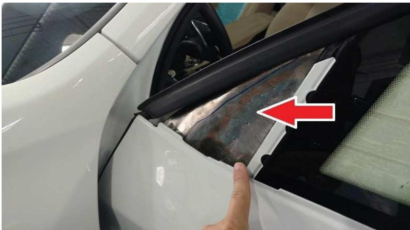
Figura 12 – Chapa de aço inox aplicada na região do retrovisor externo
