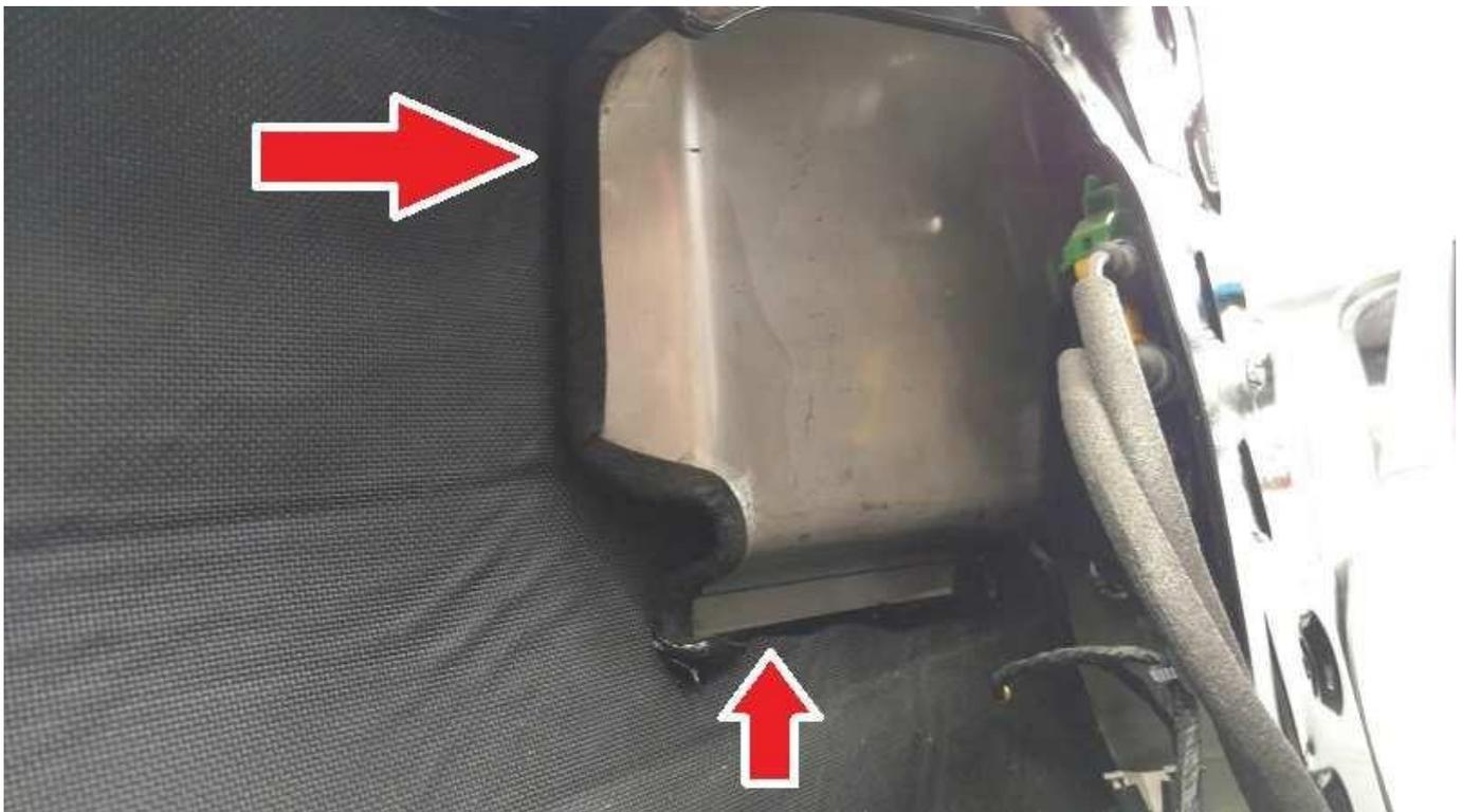
Figura 13 – Detalhe do reforço em chapa de aço inox na região da maçaneta
