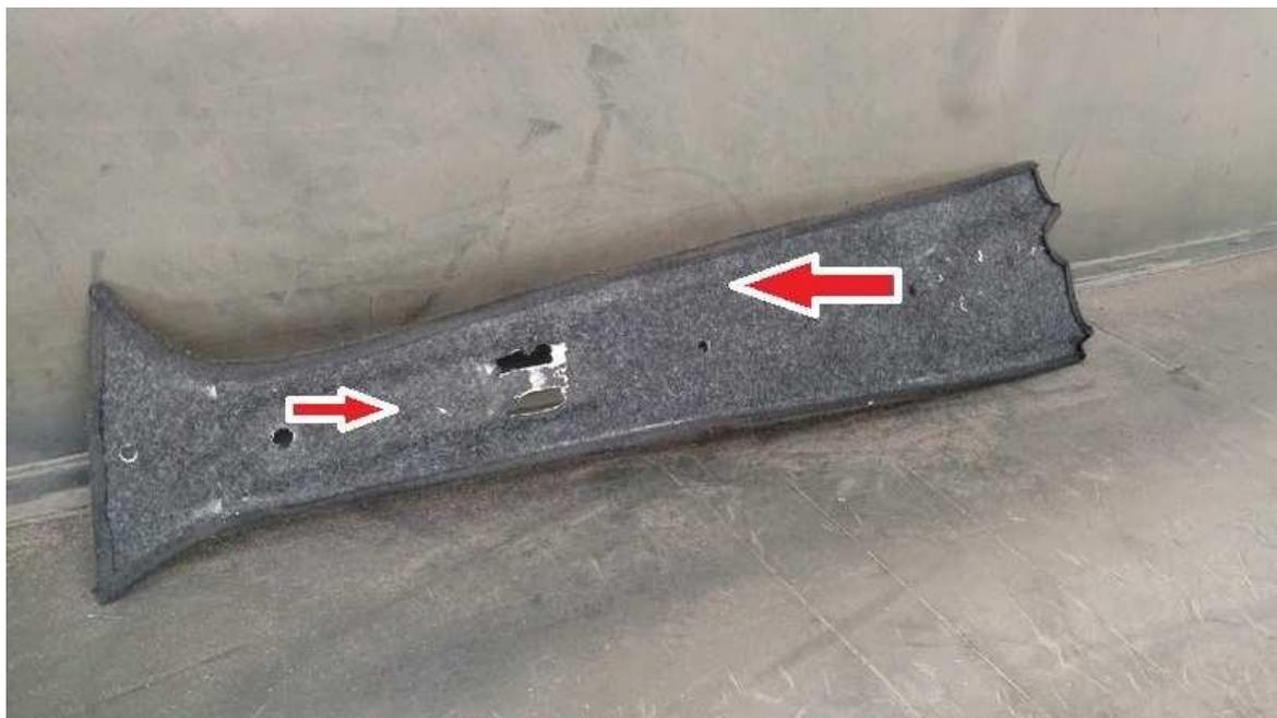
Figura 5 – Detalhe do carpete aplicado na face oposta da chapa de aço
