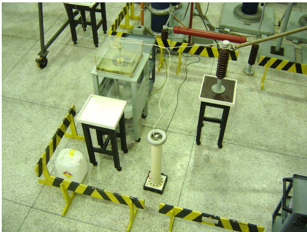
Fig.02– Arranjo do ensaio de rigidez dielétrica.
