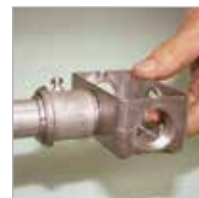
Eletroduto e Conector com as Juntas de Vedações preparados para realizar a conexão IP54 no Condulete Múltiplo correspondente.
