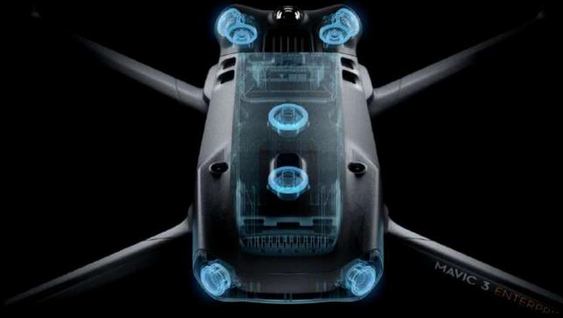
Equipado com lentes grande-angulares em todos os lados para detecção de obstáculos omnidirecional sem nenhum ponto cego. Ajuste os alarmes de proximidade e a distância de frenagem de acordo com os requisitos da missão. [6]
