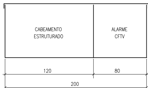
DETALHE 2a - DIVISÃO DA ELETROCALHA SEM ESCALA
