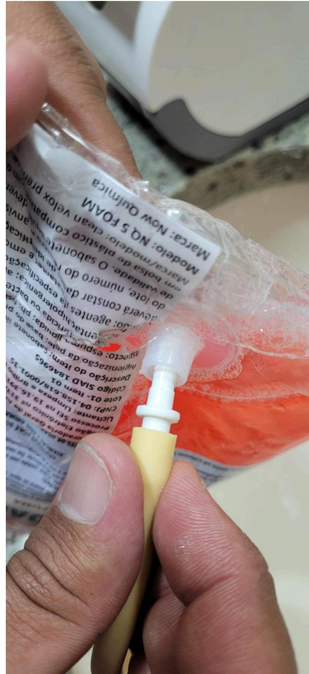
**Conclusão: Não há pressão entre o ducto e a válvula do refil, ocasionando vazamento.**
