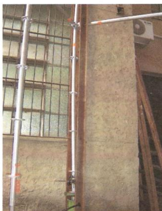
Foto 43: Ensaio em andamento – início da flambagem do poste
