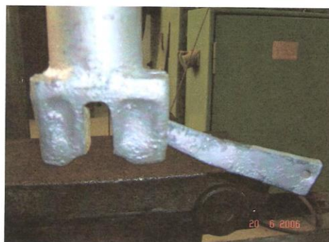
Foto 48: Detalhe da deformação permanente da cunha de engaste
