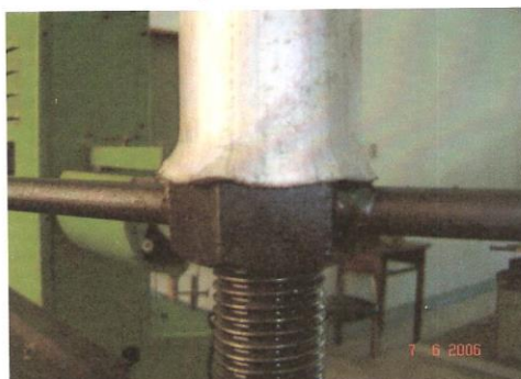
Foto 4: Detalhe da expansão da extremidade do tubo
