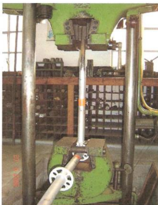
Foto 45: Início do ensaio de tração
