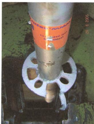
Foto 47: Detalhe da ruptura da rosácea
