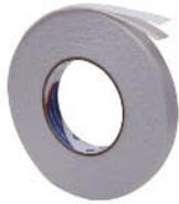
Fita dupla face de espuma de polietileno branca, com células fechadas, adesivo sintético de alta performance e liner de papel siliconado branco. Resistente à solvente.
