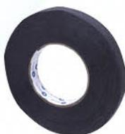
Fita adesiva com dorso de tecido 100% algodão, preto, impermeabilizado com tratamento retardante a chama e rasgo fácil, com adesivo transparente à base de borracha e resina.
