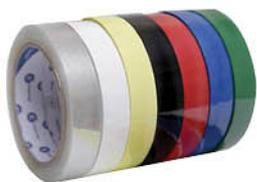
Fita adesiva com dorso em filme de poliéster com adesivo acrílico, retardante a chama, resiste à ação de solventes e óleos, utilizada para altas temperaturas (130°C). Possui padrão UL e Rohs Free. Várias opções de cores.
