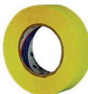
Fita adesiva com dorso em filme de poliéster com adesivo acrílico, retardante a chama, resiste à ação de solventes e óleos, utilizada para altas temperaturas (130°C). Possui padrão UL e Rohs Free.
