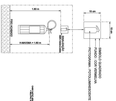
DETALHE DE INSTALAÇÃO DO EXTINTOR DE INCÊNDIO
